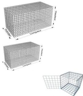
Un gabion est en génie civil un casier, le plus souvent constitué de solides fils de fer tressés et rempli de pierres non-gélives, utilisé dans les travaux publics et le bâtiment pour respectivement construire des murs de soutènement, des berge artificielles non étanche ou décorer une façade nue ou des aménagements urbains. D'un coût modique avec des pierres solides, et d'une bonne tenue, ils sont relativement faciles à mettre en œuvre et aisément modulables.
